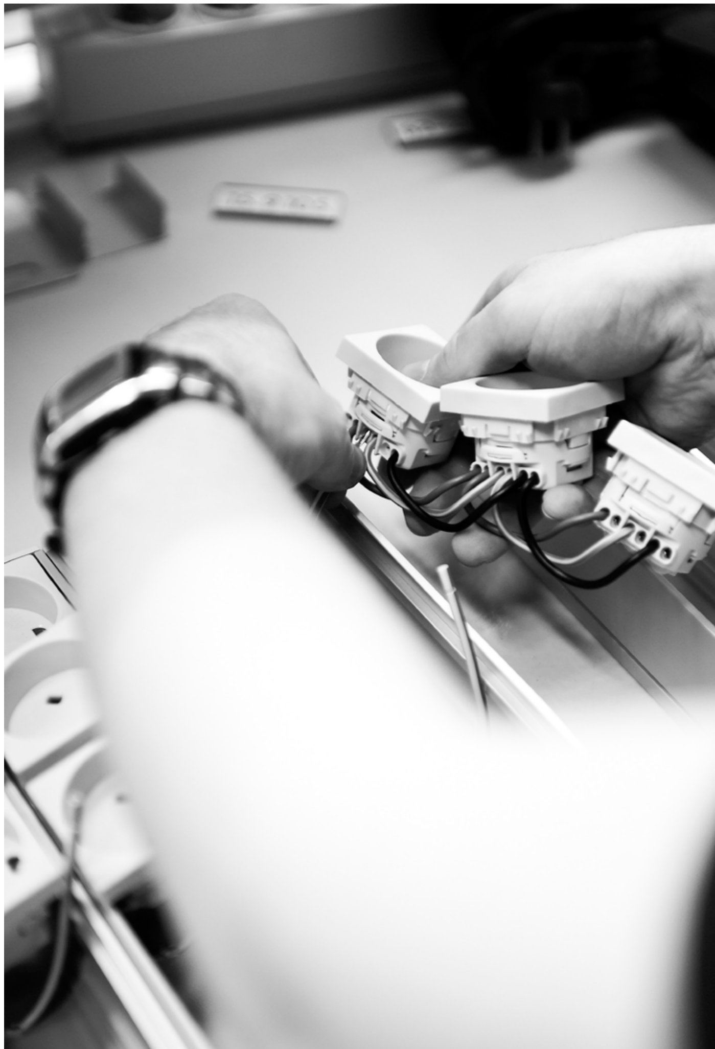
Duelco ClickSystem 45 mm komponenter monteres direkte i elpanelerne.
